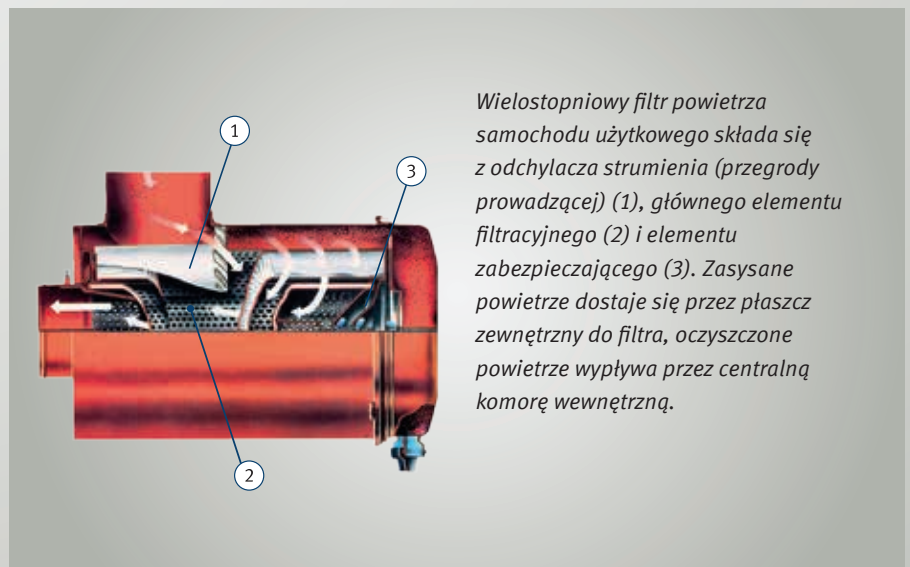
Wielostopniowy filtr powietrza do samochodów użytkowych
